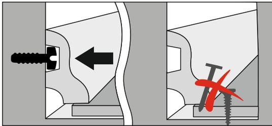
7.12 Плинтус крепится к стене. Следите за тем, чтобы плинтус не был жёстко закреплён на поверхности кварцевого паркета и обеспечивал подвижность, не фиксируя напольное покрытие.
