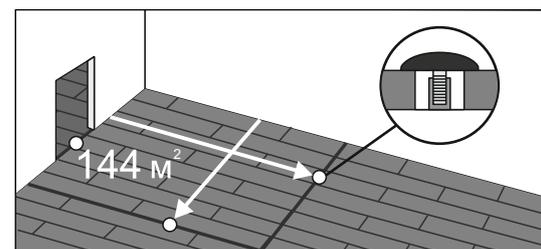
7.16 Площадь максимально возможной беспороговой укладки до 144 м<sup>2</sup> при условии, что максимальная длина и ширина непрерывного ряда должна составлять не более 12 м. При отсутствии разрывов в укладке кварцевого паркета в дверных проемах общая длина или ширина – это сумма длин или ширин всех комнат.
